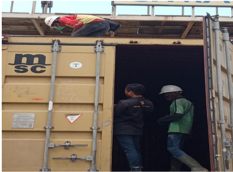
Gambar pengecekan fisik kondisi kontener
