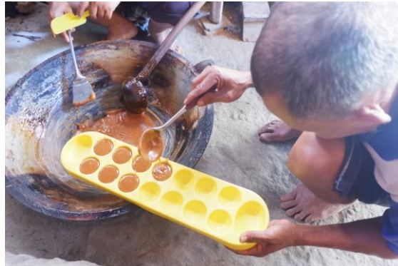
Gambar 7. Proses pencetakan gula aren dengan cetakan yang lebih rapih sebelumnya menggunakan batok kelapa sebagai alas cetaknya
