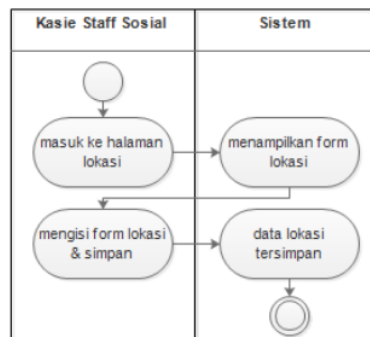
Gambar 6. Perancangan Activity Diagram Memasukkan Data Lokasi
