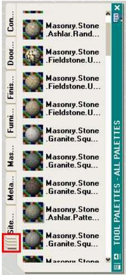
La paleta que acaba de abrir contiene todas las colecciones por defecto de AutoCAD. Puede ser que vea o no la paleta que usted necesita cuando las abre de este modo.
