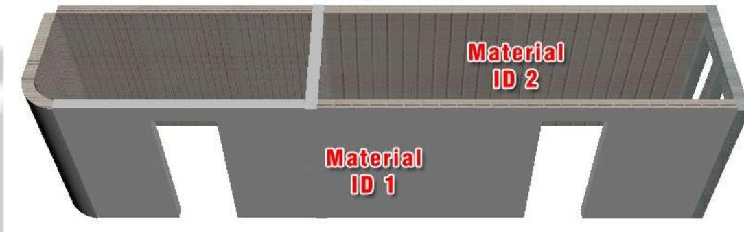
**Nota:** Hay que cambiar las ID de los muros en el interior el ID es 2, y en el exterior es 1.
