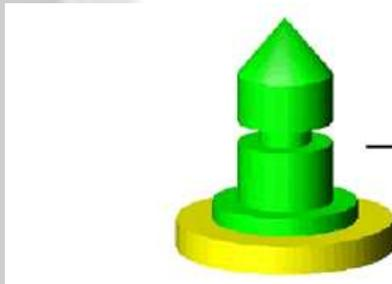
Sólido de revolución sobre un cilindro. Al ejecutar el comando simplemente debemos indicar los objetos que van a unirse.
