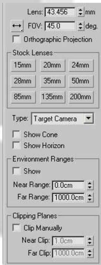
**LENS (Lentes).**-Determina la distancia focal de la cámara, hay varias opciones predeterminadas en los botones, el objetivo se puede ampliar o reducir, lo cual producirá un incremento o un estrechamiento en el campo visual.
