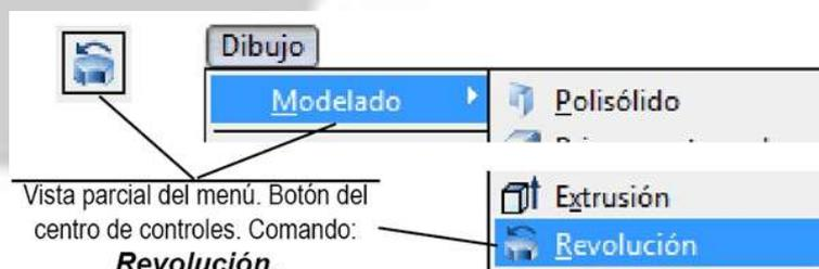
El perfil a convertir en un sólido con el comando **Revolucion** es una polilínea. La línea es otro objeto que va a servir como eje.
