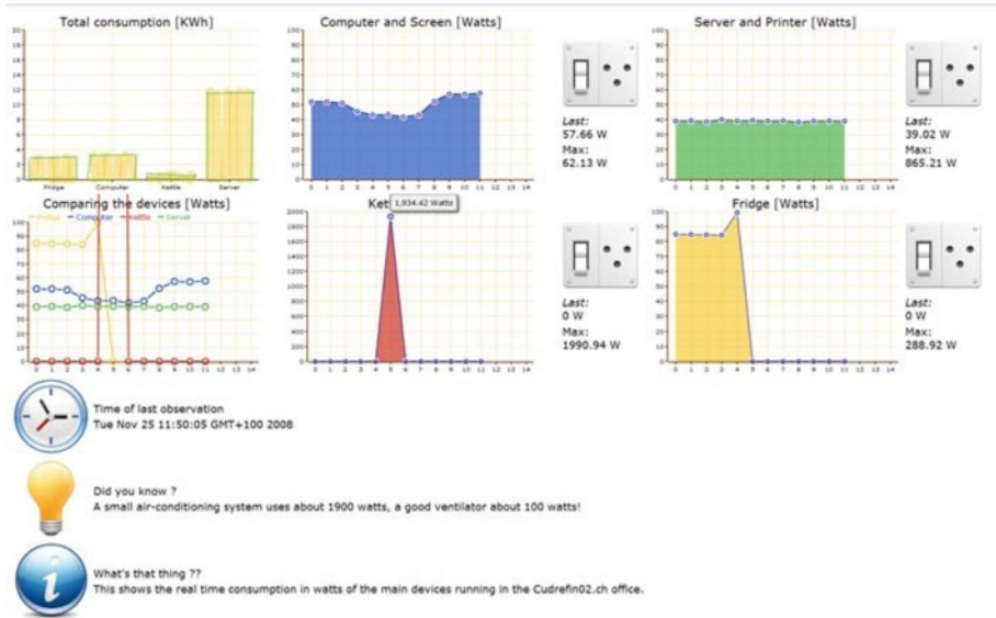
Fig. 14.19 Energy monitoring per machine
