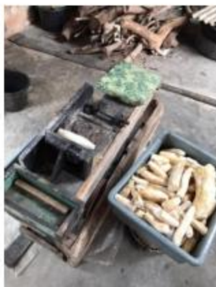
Alat yang digunakan untuk merajang singkong tipis-tipis
