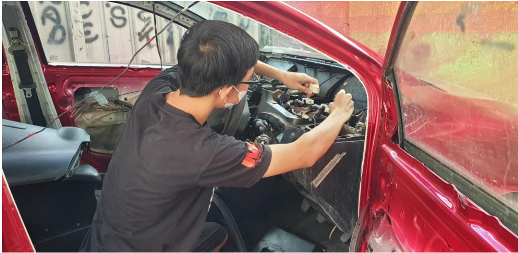
Cek perkabelan Vios gen 2
