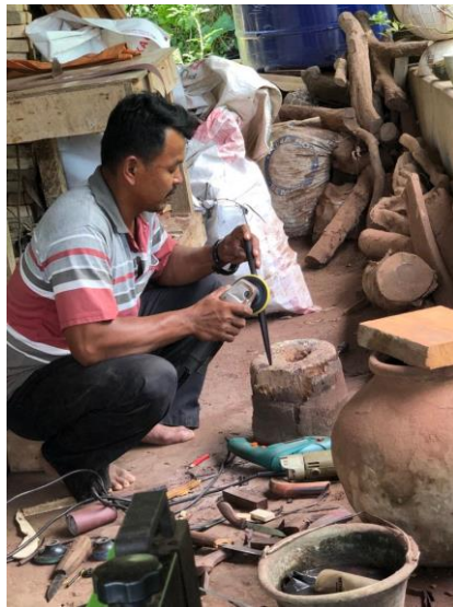
Gambar 2.5 Kegiatan Produksi Pembentukan Sangkur Tongkat Komando
