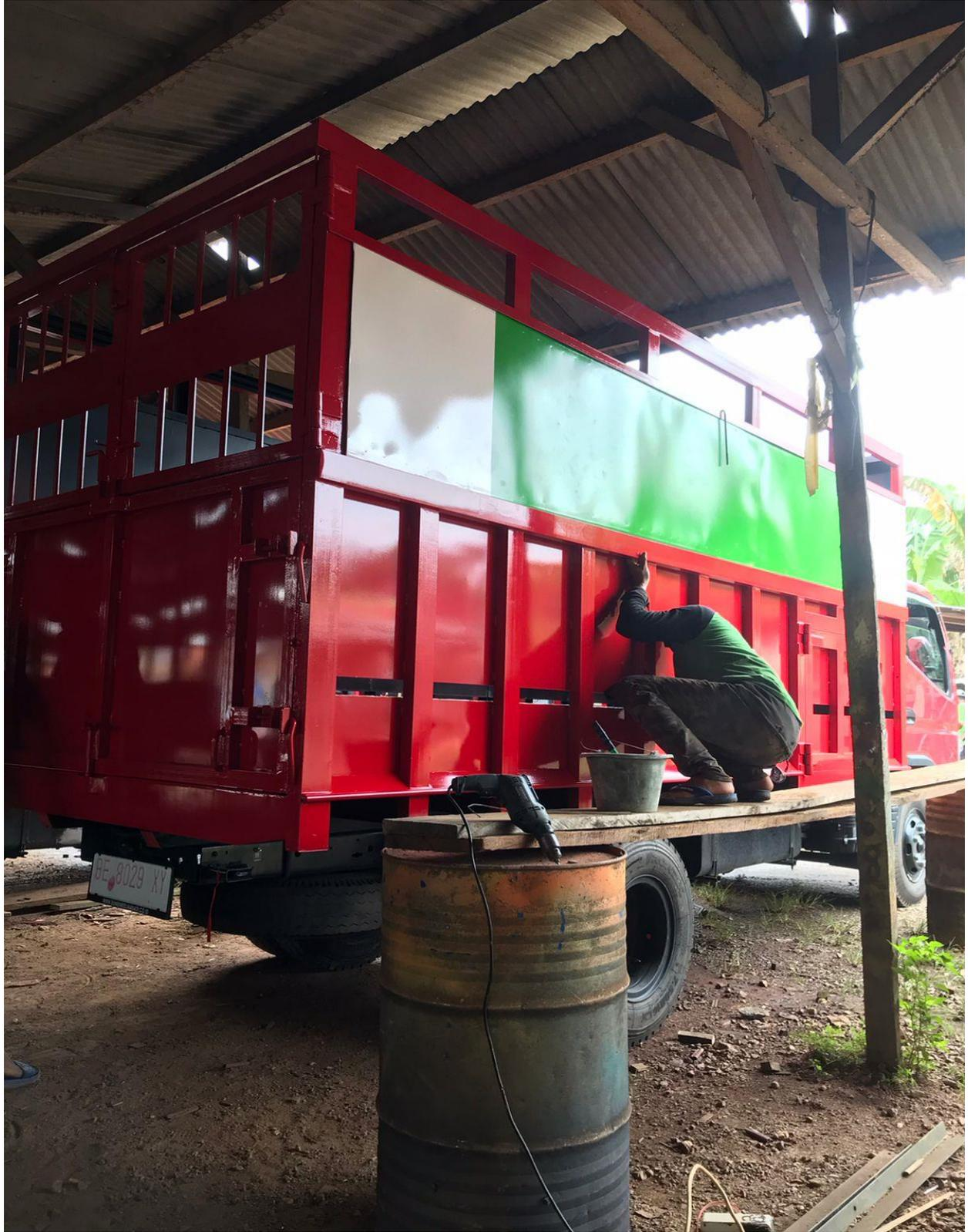
*Pemasangan aksesoris pada produk setelah pengecat-an*
