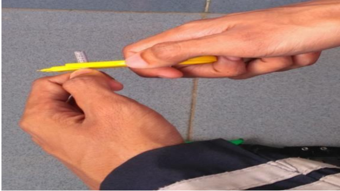
Gambar 2.. Mengupas kabel UTP ) Kupas bungkus luar kabel, seruas jari kelingking dan berhati-hati jangan sampai kabel kecil didalamnya terpotong. Urut-urut kabel kecil didalamnya agar lurus, agar mudah dimasukan ke konektor RJ45
