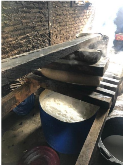
Gambar 2.6 Alat penyaring kedelai Alat penyaring kedelai tradisional yang dibuat sendiri menggunakan kayu balok
