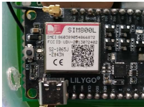
Gambar 2. 4 Built-in modul SIM800L pada ESP32
