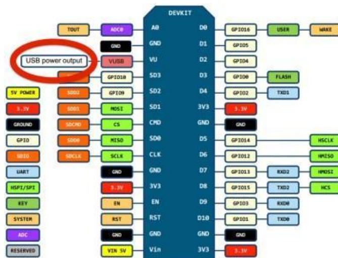
Gambar 2.5 GPIO NodeMCU ESP8266 v3
