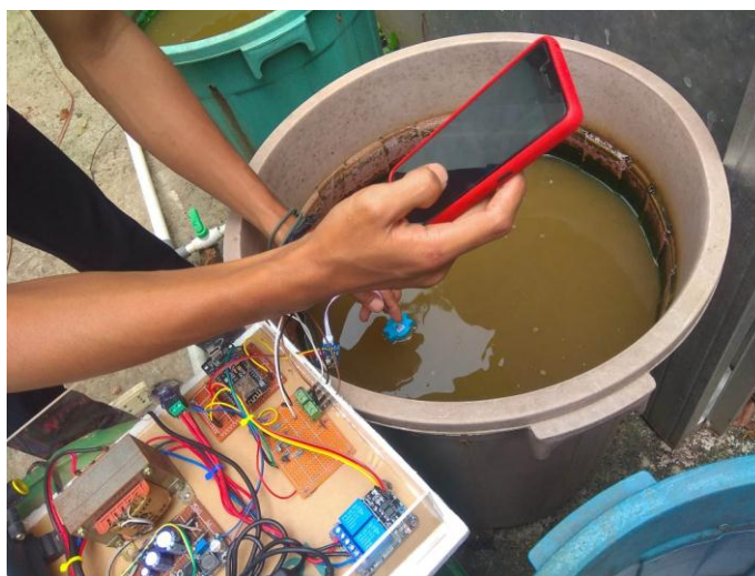
Gambar 4.3. Pengujian Sensor Turbidity Pada Kolam Ikan Lele
