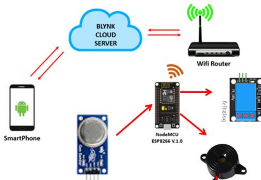
Gambar 3.8 Skematik Sistem Monitoring Polusi Udara
