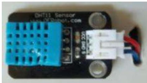
**Gambar 2.1 Sensor DHT 11**
