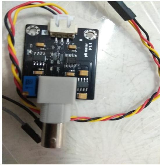
Gambar 2.7 Modul DFRobot PH Meter v1.1
