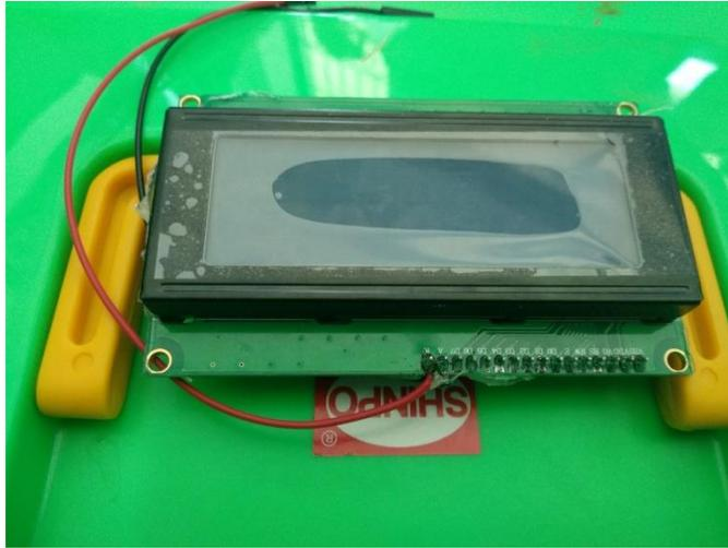
Gambar 2.19 LCD 20x4
