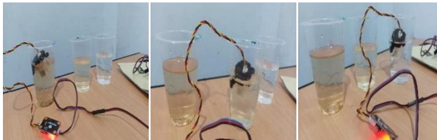
Gambar 4.2 Pengujian Sensor Turbidity untuk Sampel Air Ember 1 (a), Sampel Air Ember 2 (b), Sampel Air Sumur (c)
