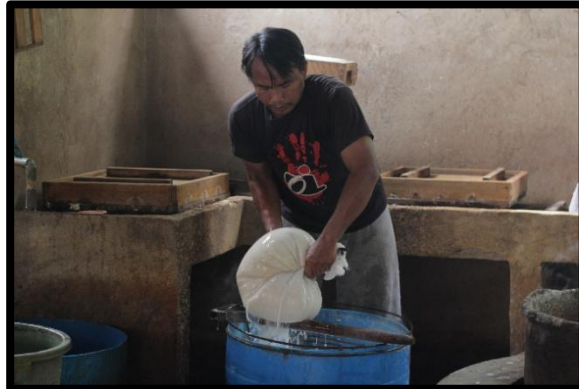
Gambar 2.2 Proses pemisahan Sari Kedelai Dengan Ampas
