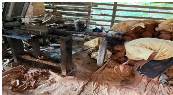
Gambar 2.3 Proses pembuatan bata dan genteng.
