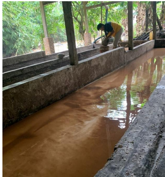
Gambar 2.9 proses pengendapan ke 2 untuk mendapatkan sari sagu bersih
