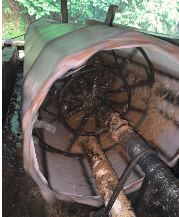
Gambar 2.6 Proses penyaringan 1 untuk memisahkan serat dan sari
