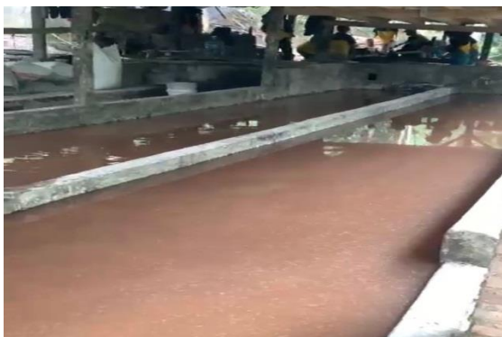
Gambar 2.7 Proses pengendapan 1 untuk mendapatkan sari sago
