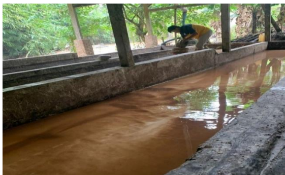
Gambar 2.9 Proses pengendapan ke 2 untuk mendapatkan sari sago bersih
