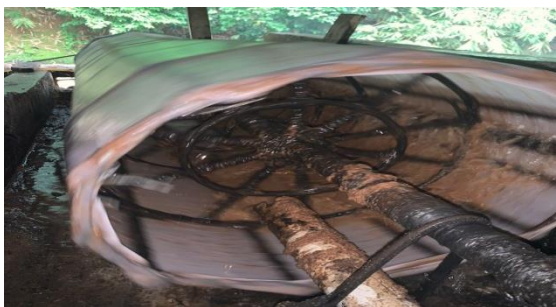
Gambar 2.6 Proses penyaringan 1 untuk memisahkan serat dan sari
