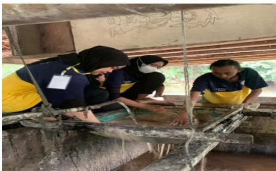
Gambar 2.8 proses penyaringan ke 2 atau pemutihan untuk membersihkan kotoran yang tersisa
