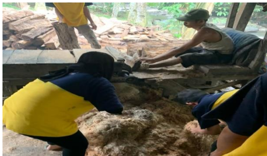
Gambar 2.4 Proses penggilingan batang sugu
