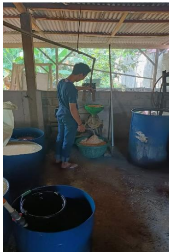
Gambar 1. Proses penggilingan kedelai
