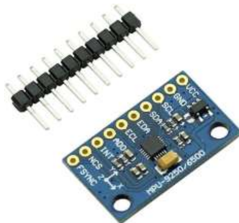
Gambar 2.2 Sensor Accelerometer MPU-9250 Pada Smartphone (Sumber www.forum.arduino.cc )
