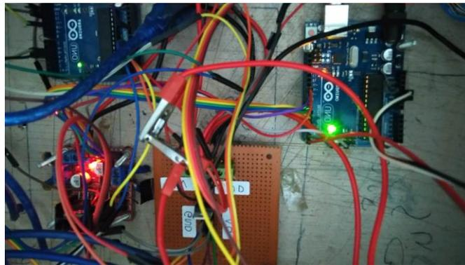
Gambar 4.1 Rangkaian Arduino Uno dan Motor Driver L298N
