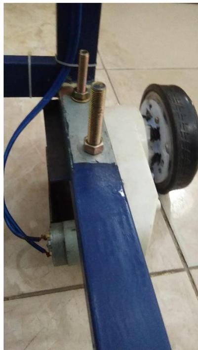
Gambar 4.6 Motor DC pada roda *smart trolley*.
